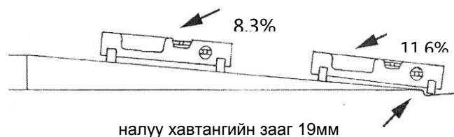
70-р зураг - Налуу хавтангийн хэвгий 8,3 %, налуу хавтангийн үзүүрийн 19 мм уртын хэвгий 11,6 % байх нь тэргэнцэртэй зорчигчдод тохиромжтойг харуулав.
