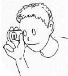
120-р зураг - Зогсоолуудын хоорондох налууг хэмжидэг клинометр
