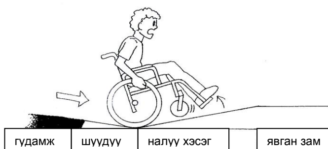
66-р зураг - Ус зайлуулах ховил ба налуу хавтангийн хоорондох богино зайнд байх хэвгийн өөрчлөлт нь тэргэнцэртэй зорчигч ар тал руугаа унах аюулд хүргэж байна.
