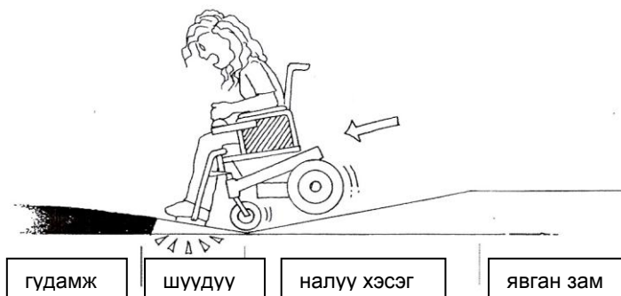
65-р зураг - Налуу хавтан ба ус зайлуулах ховилын хоорондох богино зай дахь хэвгийн өөрчлөлт нь тэргэнцэртэй зорчигчид аюултай байна.
