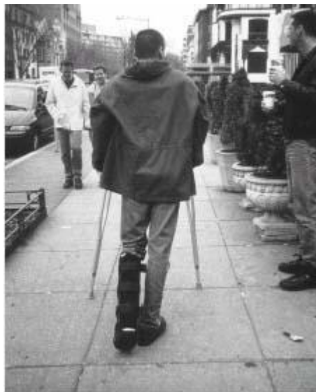
3-р зураг - Явган хүний замын хамгийн бага өргөн 1500 мм байна. Энэ хэсэгт элдэв саад болон ил цухуйсан зүйлс байж болохгүй.
